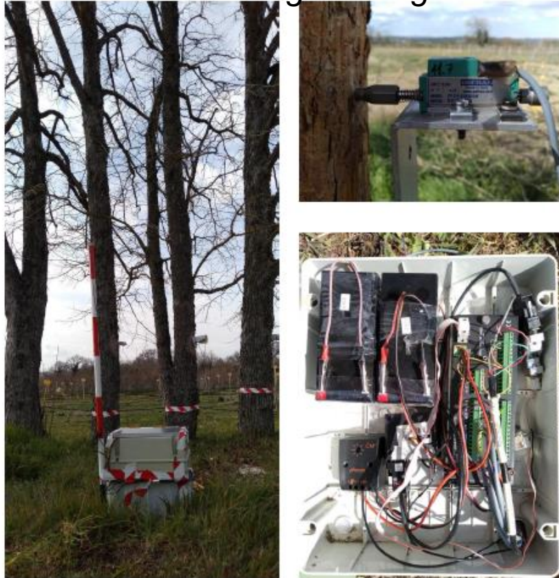
Figura 3. Dendrometri installati su 4 piante di C.columna . dettaglio di dendrometro lineare. Interni della scatola con datalogger e batteria.
